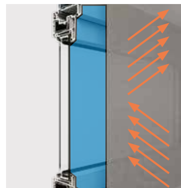
Außenliegender Sonnenschutz wirkt am effektivsten.
